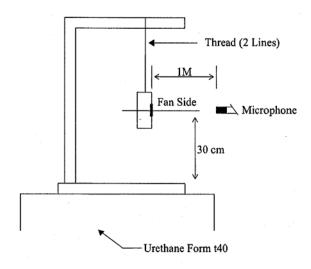
1 METER FROM MICROPHONE TO FAN INTAKE
